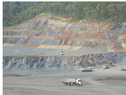
รูปที่ 2-14: การทำเหมืองแบบขั้นบันได
