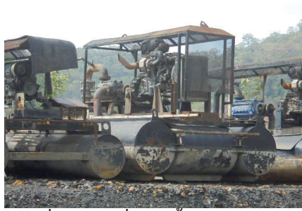
รูปที่ 2-41: เครื่องสูบน้ำจากขุมเหมือง
