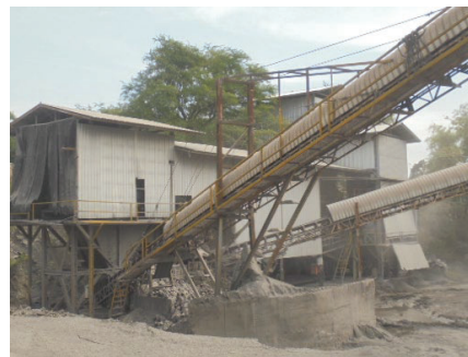
รูปที่ 2-30: การปิดคลุมสายพานลำเลียงแร่
